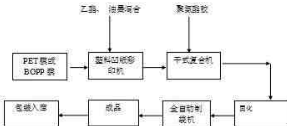
图2-2 生产工艺流程及产污环节图
